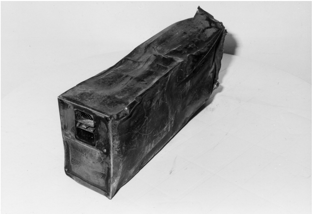
Foto: Politie luchtvaartdienst afd. luchtfotografie Schiphol-Oost Flight Data Recorder (uit verongelukte toestel)
